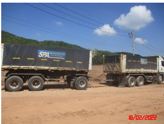
รูปที่ 2-21 การใช้ผ้าใบปิดคลุมกระบะรถบรรทุก
