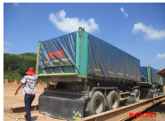
รูปที่ 2-21 การใช้ผ้าใบปิดคลุมกระบะรถบรรทุก
