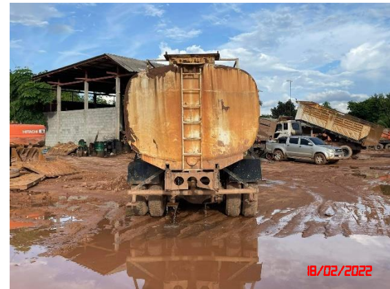
รูปที่ 2-23 การฉีดพรมน้ำตามเส้นทางขนแร่
