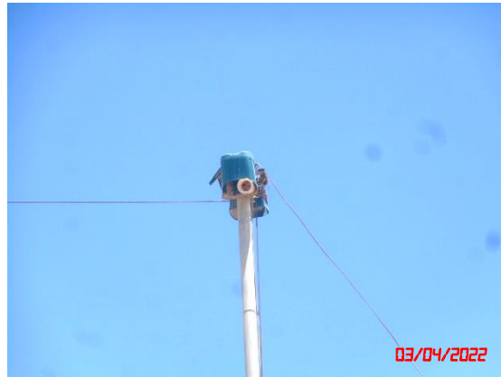
รูปที่ 2-19 เครื่องส่งสัญญาณแจ้งเตือนก่อนทำการระเบิด
