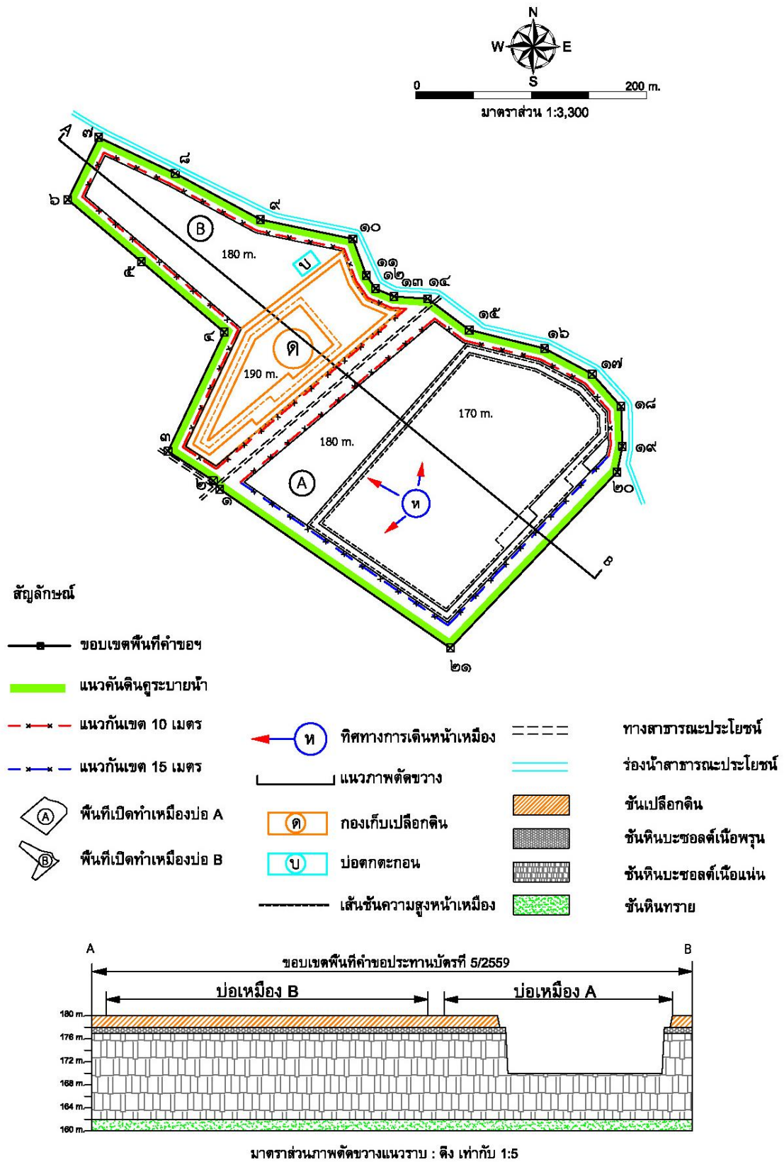
รูปที่ 1-6 แผนผังการทำเหมืองเมื่อสิ้นสุดปีที่ 2
