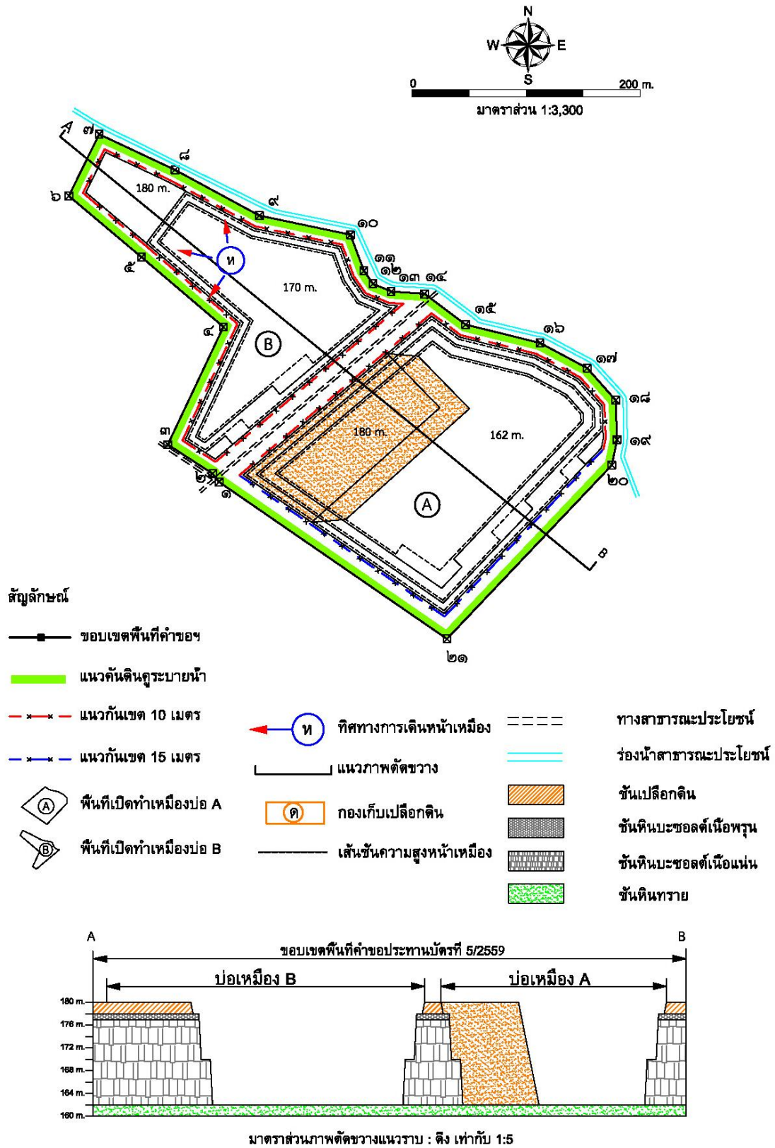
รูปที่ 1-8 แผนผังการทำเหมืองเมื่อสิ้นสุดปีที่ 6
