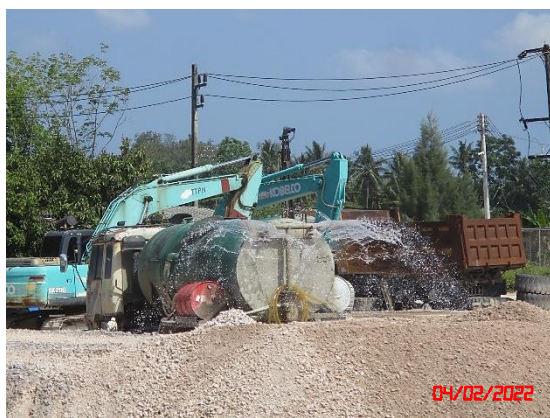
รูปที่ 2-18 รถฉีดพรมน้ำบริเวณเส้นทางขนส่งแร่
