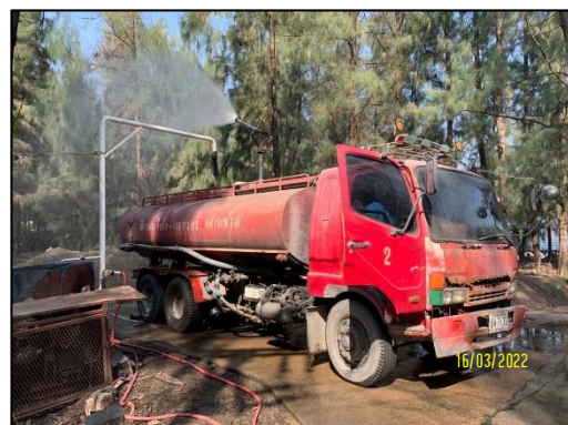
รูปที่ 2-84 รถบรรทุกน้ำ สำหรับฉีดล้างถนน และฉีดพรมน้ำ ดับเพลิงบริเวณโดยรอบพื้นที่ลานกองเชื้อเพลิง
