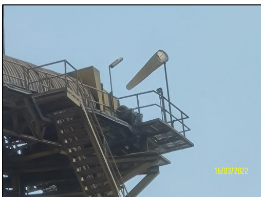
รูปที่ 2-29 ติดตั้งถ่วงลมบนสายพานลำเลียงขานอ้อย
