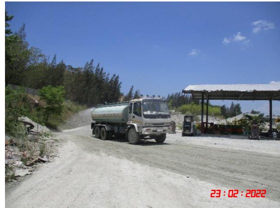
รูปที่ 2-10 การฉีดพรมน้ำเพื่อลดการฟุ้งกระจายของฝุ่นละออง
