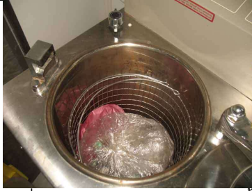
ภาพที่ 6-D เครื่อง Auto Clave สำหรับฆ่าเชื้อขยะติดเชื้อ จากห้องปฏิบัติการ ก่อนส่งกำจัดที่เตาเผาเทศบาลนคร ภูเก็ตทุกวัน
