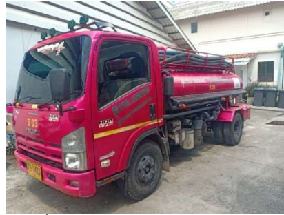
ภาพที่ 3-C สูบลบตะกอนส่วนเกินไปกำจัด ทุกวันที่ 10,20,30 ของเดือน
