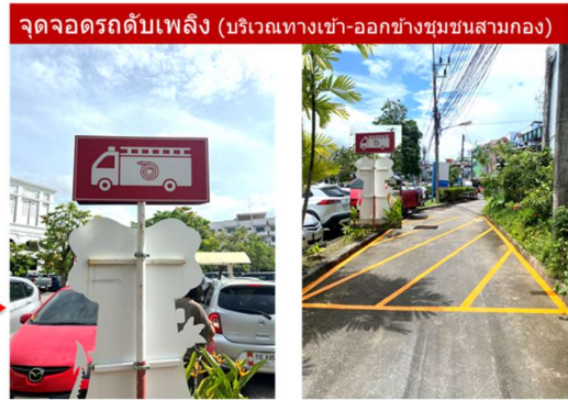
ภาพที่ 11-E ดำเนินการจัดทำช่องสำหรับจอดรถดับเพลิงในกรณีฉุกเฉิน ในบริเวณที่ใกล้กับจุดหัวรับน้ำดับเพลิงตามที่กฎหมายกำหนด
