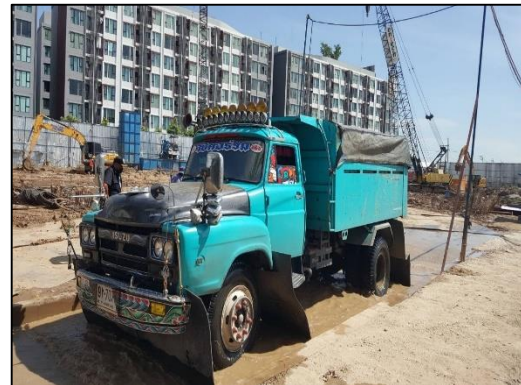
ภาพที่ 10 ผ้าใบคลุมรถบรรทุกที่ใช้ขนส่งวัสดุก่อสร้าง
