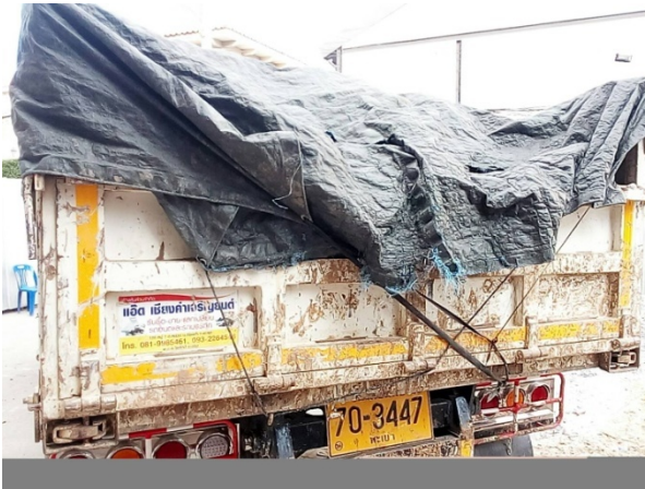
ภาพที่ 6-20 เก็บขนเศษวัสดุก่อสร้างออกนอกพื้นที่โครงการด้วยรถบรรทุก และปิดคลุมท้ายรถอย่างมิดชิดก่อนออกจากโครงการ
