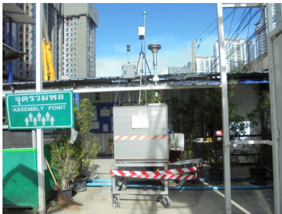
จุดตรวจวัดก๊าซมลพิษ CO SO 2 NO 2 และ HC ตรวจวัดฝุ่นละออง เสียงและแรงสั่นสะเทือนที่พื้นที่โครงการ และแรงสั่นสะเทือนที่โรงเรียนกันตทาราราม
