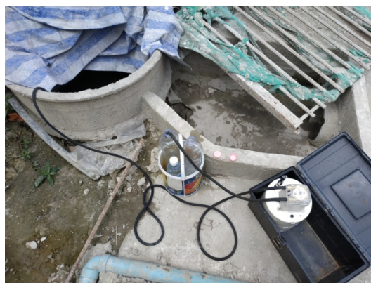
จุดเก็บตัวอย่างน้ำทิ้งบ่อพักน้ำทิ้ง พื้นที่โครงการ
