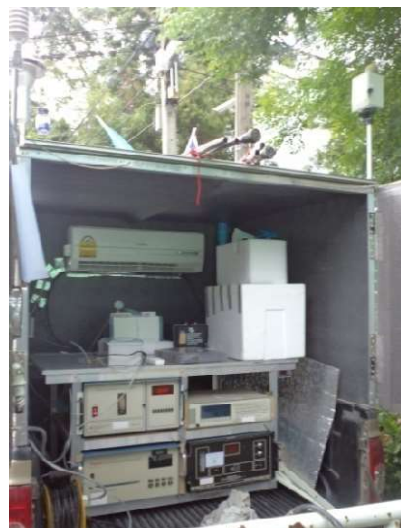
จุดตรวจวัดก๊าซมลพิษ CO SO 2 NO 2 และ HC ตรวจวัดฝุ่นละออง เสียงและแรงสั่นสะเทือนที่พื้นที่โครงการ และแรงสั่นสะเทือนที่โรงเรียนกันตทาราราม
