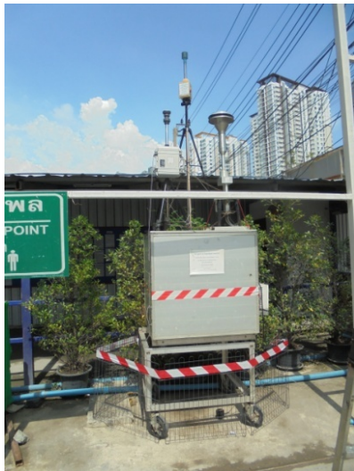
จุดตรวจวัดก๊าซมลพิษ CO SO 2 NO 2 และ HC ตรวจวัดฝุ่นละออง เสียงและแรงสั่นสะเทือนที่พื้นที่โครงการ และแรงสั่นสะเทือนที่โรงเรียนกันตทาราราม
