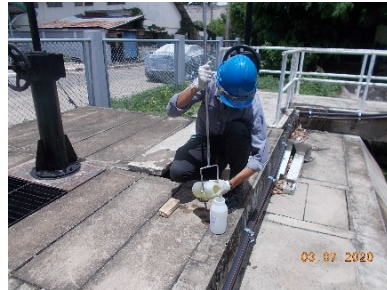
บ่อดตรวจคุณภาพ ซึ่งเป็นบ่อกักสุดท้ายก่อนระบายน้ำทิ้งลงสู่ระบายน้ำของโครงการอาคารเช่าเดิม
