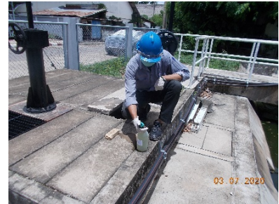
บ่อดตรวจคุณภาพ ซึ่งเป็นบ่อกักสุดท้ายก่อนระบายน้ำทิ้งลงสู่ระบายน้ำของโครงการอาคารเช่าเดิม
