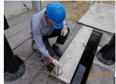
บ่อบรรจุน้ำเสีย ซึ่งเป็นบ่อกักสุดท้ายก่อนระบายน้ำทิ้งลงสู่ระบายน้ำของโครงการอาคารเช่าเดิม
