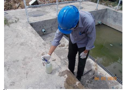
บ่อกักน้ำเสียก่อนไหลเข้าบ่อสูบของระบบบำบัดน้ำเสียรวม
