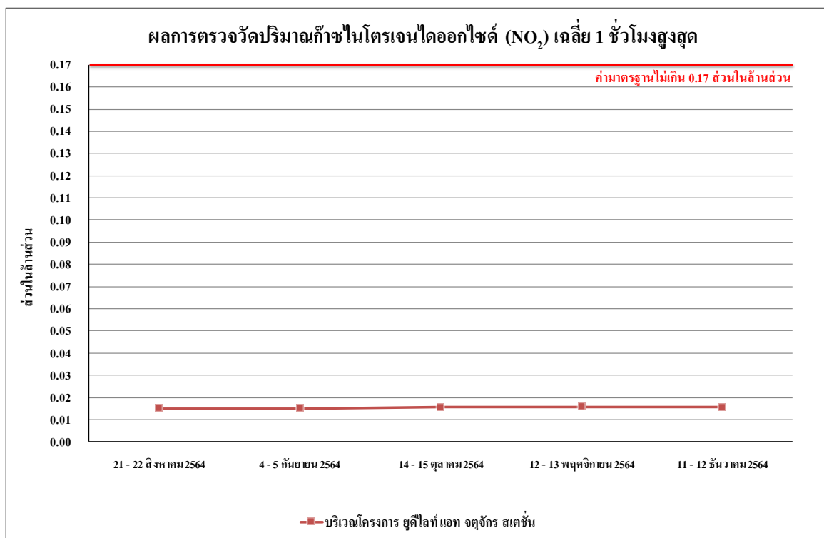
รูปที่ 4.4-14 ผลการตรวจวัดปริมาณก๊าซไนโตรเจนไดออกไซด์ (NO 2 ) เฉลี่ย 1 ชั่วโมงสูงสุด บริเวณโครงการ ยูทีไลท์ แอธ จตุจักร สเตชั่น ระหว่างเดือนกรกฎาคม - ธันวาคม 2564
