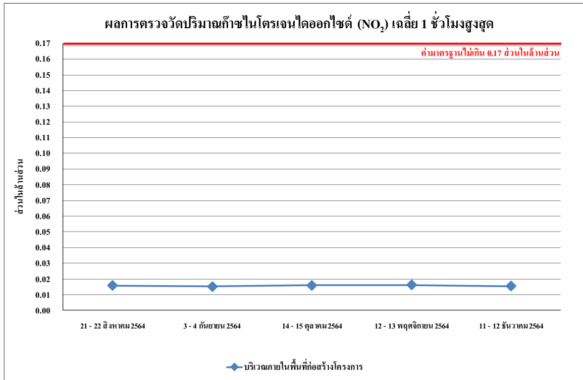
รูปที่ 4.4-13 ผลการตรวจวัดปริมาณก๊าซไนโตรเจนไดออกไซด์ (NO 2 ) เฉลี่ย 1 ชั่วโมงสูงสุด บริเวณภายในพื้นที่ก่อสร้างโครงการ ระหว่างเดือนกรกฎาคม - ธันวาคม 2564
