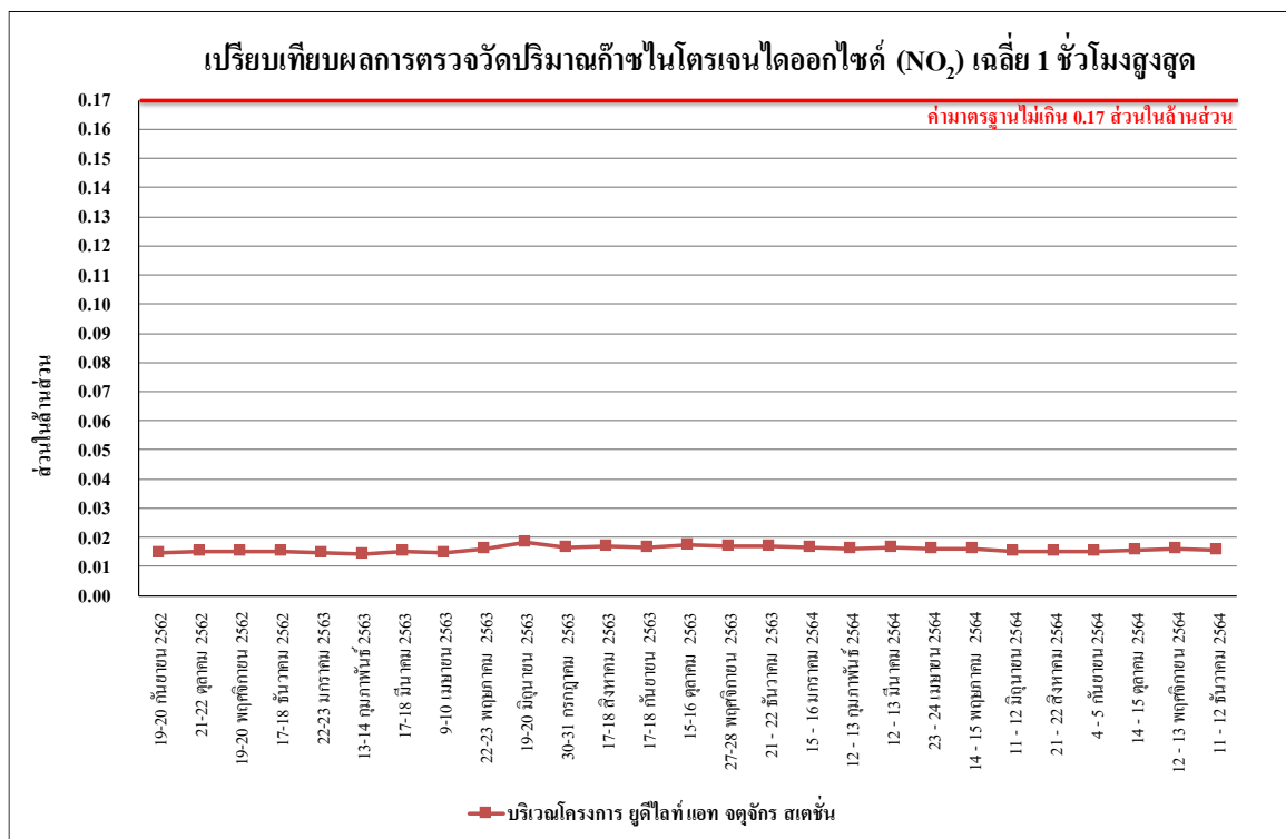
รูปที่ 4.4-30 เปรียบเทียบผลการตรวจวัดปริมาณก๊าซไนโตรเจนไดออกไซด์ (NO 2 ) เฉลี่ย 1 ชั่วโมงสูงสุด บริเวณโครงการ ยูทีไลท์ แอท จตุจักร สเตชั่น ระหว่างเดือนกันยายน 2562 - ธันวาคม 2564
