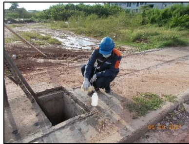
บ่อพักตรวจวัดคุณภาพน้ำก่อนระบายออกสู่แหล่งน้ำสาธารณะ
