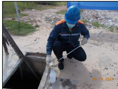
บ่อพักตรวจวัดคุณภาพน้ำก่อนระบายออกสู่แหล่งน้ำสาธารณะ
