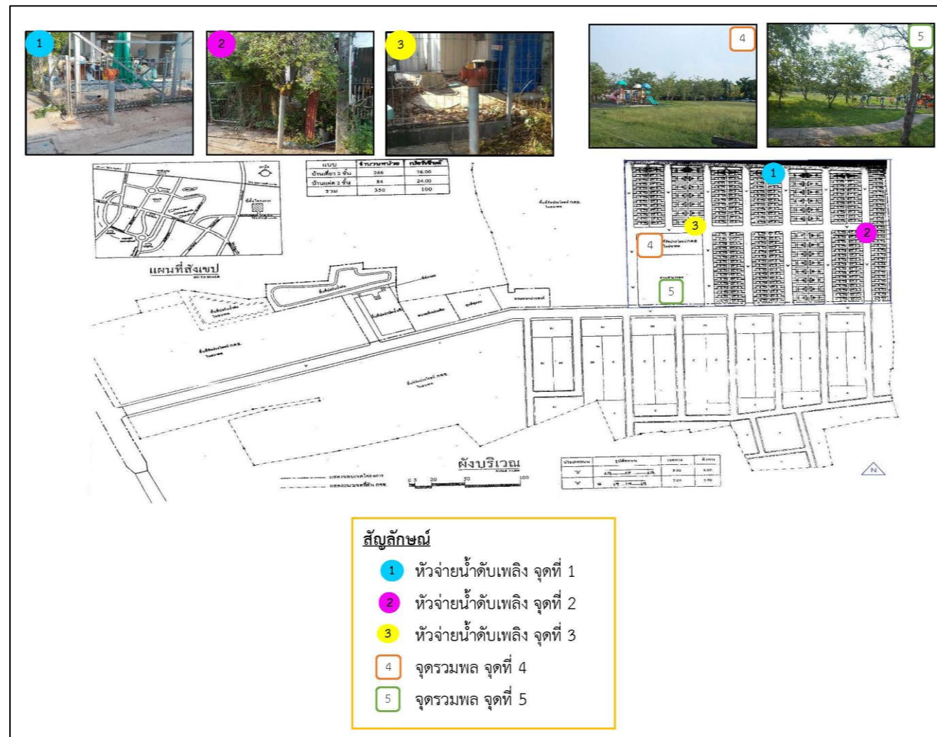
รูปที่ 2-1 ผังแสดงตำแหน่งหัวจ่ายน้ำดับเพลิงและจุดรวมพลในพื้นที่โครงการ
