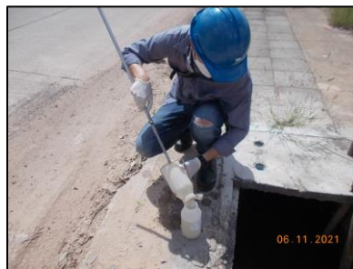
บ่อพักตรวจวัดคุณภาพน้ำก่อนระบายออกสู่แหล่งน้ำสาธารณะ รูปที่ 3-6 แสดงการเก็บตัวอย่างน้ำทิ้ง เดือนพฤศจิกายน 2564
