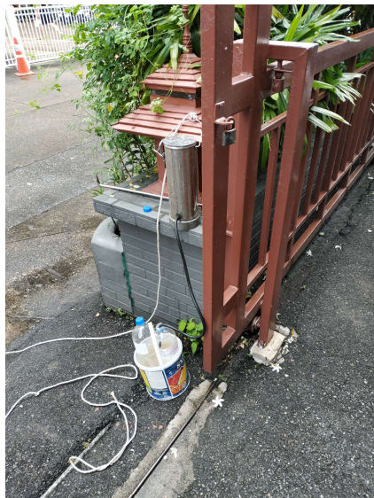
ภาพที่ 5 เก็บตัวอย่างที่ป่อตรวจคุณภาพน้ำทีก่อนระบายออกสู่ท่อระบายน้ำสาธารณะ
