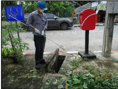
บ่อฟักน้ำทิ้งที่ออกจากถังตกตะกอนก่อนระบายออกสู่ภายนอกโครงการ รูปที่ 3-2 แสดงการเก็บตัวอย่างน้ำทิ้ง เดือนตุลาคม 2564
