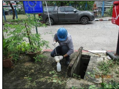
บ่อฟักน้ำทิ้งที่ออกจากถังตกตะกอนก่อนระบายออกสู่ภายนอกโครงการ รูปที่ 3-2 แสดงการเก็บตัวอย่างน้ำทิ้ง เดือนตุลาคม 2564
