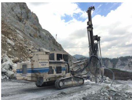
รูปที่ 2-28: เครื่องเจาะรื้อระเบิดแบบตีนตะขาบ
