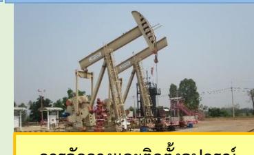
การจัดวางและติดตั้งอุปกรณ์การผลิตบนพื้นคอนกรีตที่มีรางระบายน้ำล้อมรอบ
