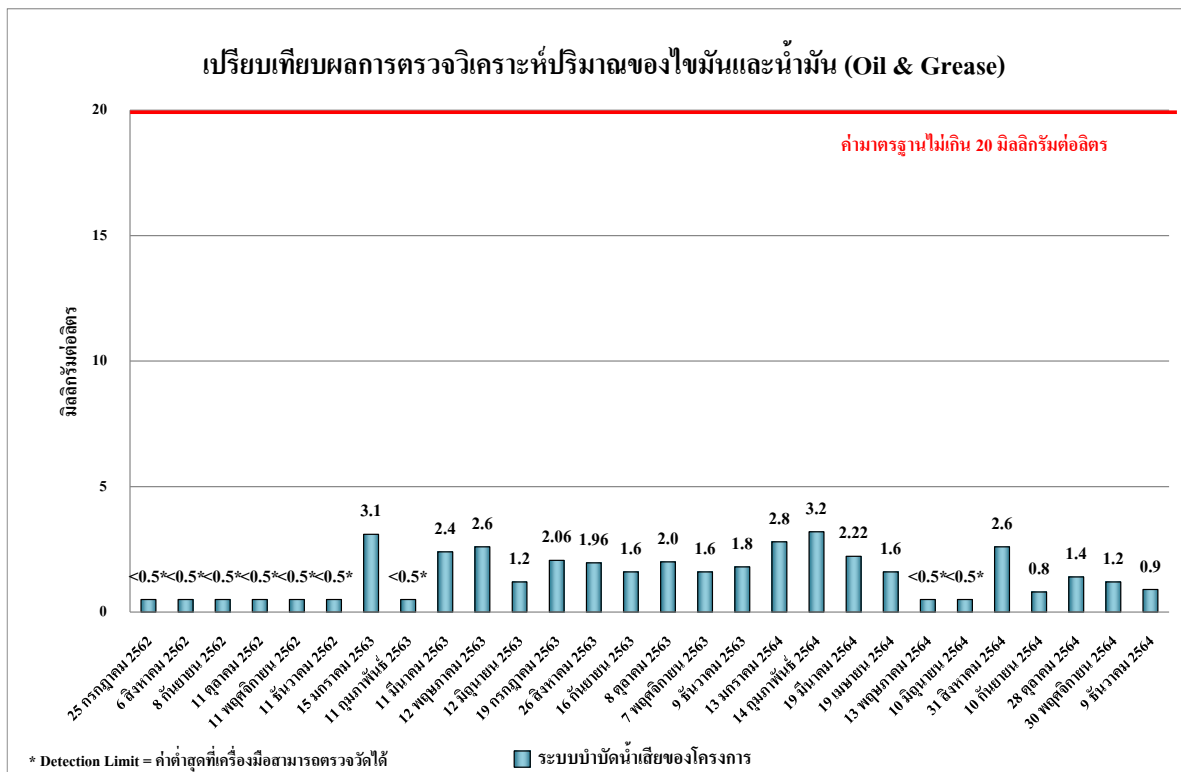
รูปที่ 4.4-48 เปรียบเทียบผลการตรวจวิเคราะห์ปริมาณของไขมันและน้ำมัน (Oil & Grease) บริเวณบ่อบำบัดน้ำทิ้งพื้นที่โครงการ ระหว่างเดือนกรกฎาคม 2562-ธันวาคม 2564
