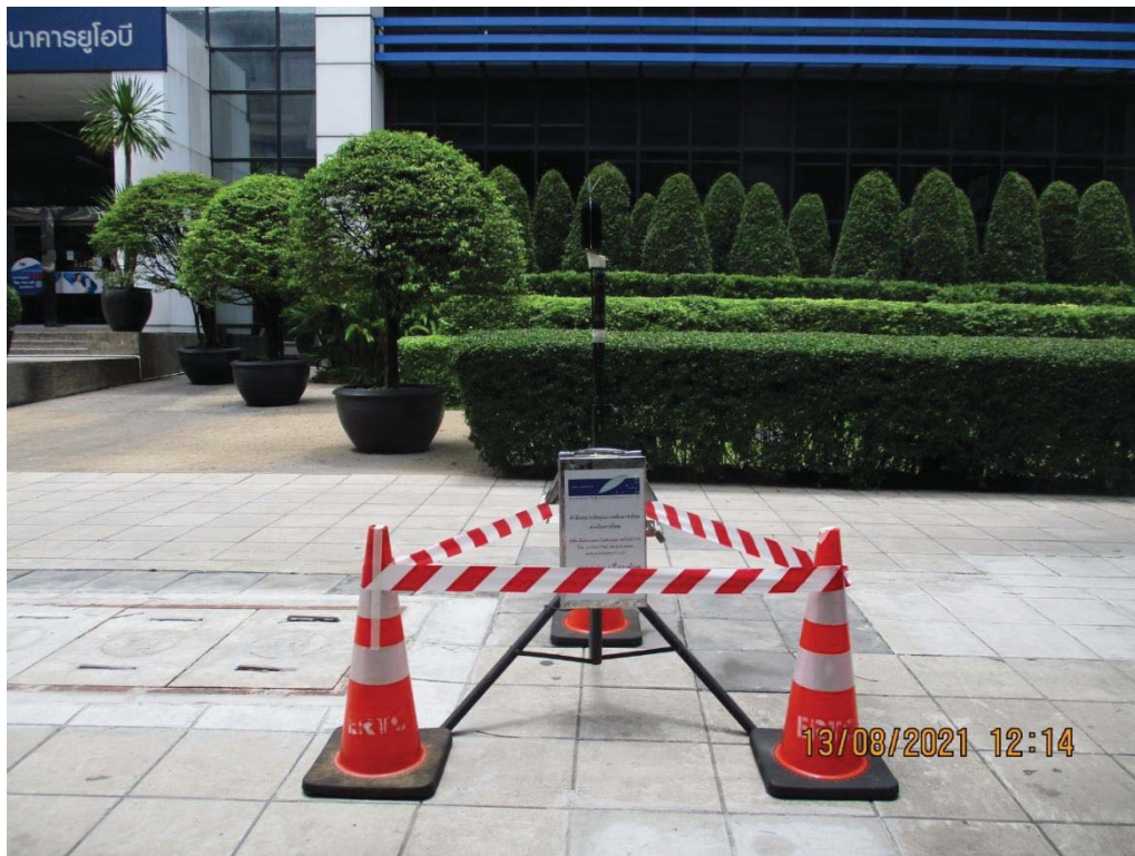
ภาพที่ 3.5-1 การติดตามตรวจสอบระดับเสียง ระยะดำเนินการ ครั้งที่ 3 วันที่ 13-18 สิงหาคม 2564
