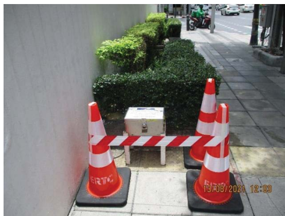
ภาพที่ 3.6-2 การติดตั้งเครื่องตรวจวัดความสั่นสะเทือน ระยะดำเนินการ ครั้งที่ 3 วันที่ 13-18 สิงหาคม 2564
