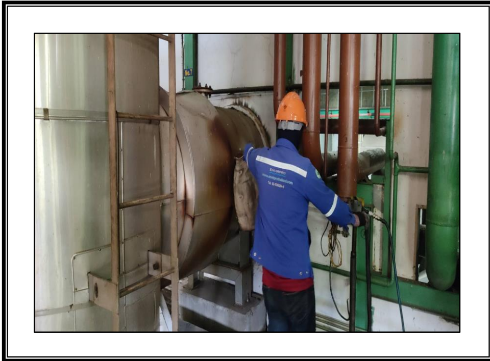
รูปที่ 3.6 จุดตรวจวัดคุณภาพอากาศจากปล่องปล่อยทิ้งอากาศเสีย บริเวณปล่อง Waste Heat Boiler ที่ต่อกับเครื่องยนต์ Mitsubishi ในวันที่ 25 ตุลาคม พ.ศ. 2564
