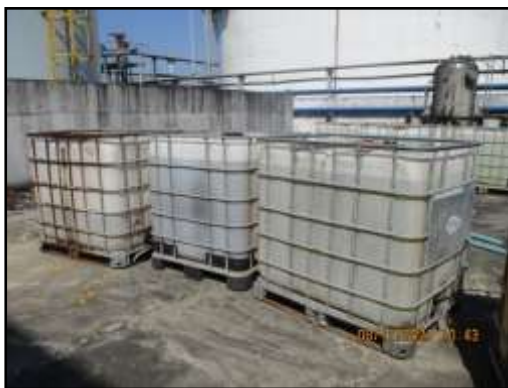
รูปที่ 2-10 ถังเก็บฟูเซลอยล์
