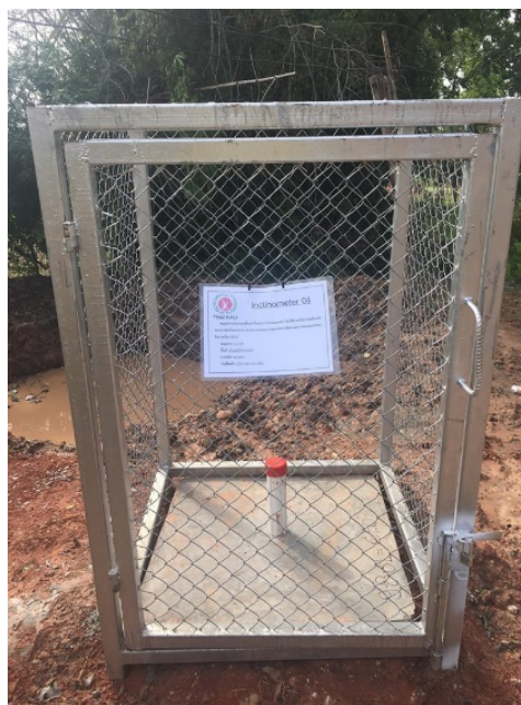
รูปที่ 3.7-11 หลุมตรวจวัดการเคลื่อนตัวของมวลดินในแนวราบบริเวณพื้นที่ก่อสร้างอุโมงค์แนวลาดและอุโมงค์แนวตั้ง
