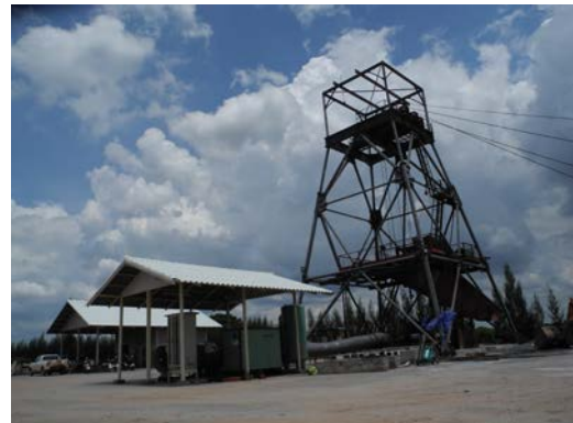
รูปที่ 2-58 ดำเนินการติดตั้งอุปกรณ์ก่อสร้างอุโมงค์ แนวตั้ง (Vertical Shaft) เพื่อใช้สำหรับติดตั้งพัดลม ระบายอากาศออกจากเหมืองใต้ดิน
