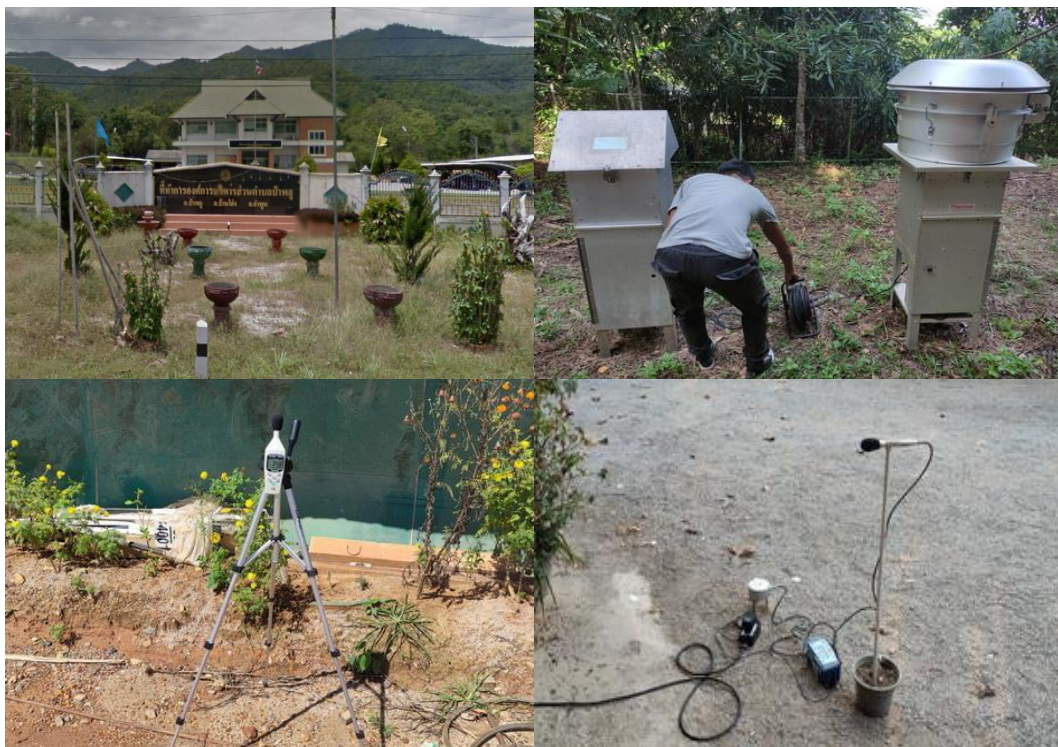
รูปที่ 3-2 การตรวจวัดคุณภาพอากาศบริเวณชุมชนป่าพลู ทำการตรวจวัดฝุ่นละอองรวม ระดับเสียง และความสั่นสะเทือน
