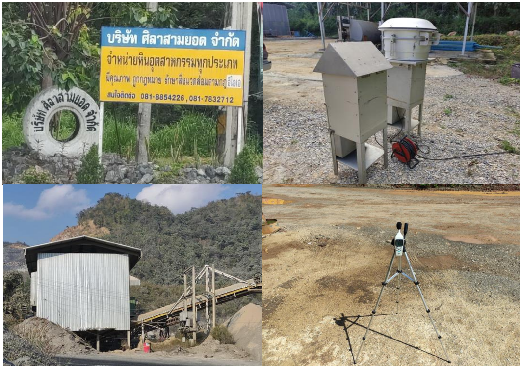
รูปที่ 3-4 การตรวจวัดคุณภาพอากาศบริเวณโรงโม่หินของโครงการ ทำการตรวจวัดฝุ่นละอองรวม ความทึบแสง และระดับเสียง
