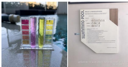
ภาพที่ 4.5-1 การตรวจวัด pH และ Free Chlorine สระว่ายน้ำ
