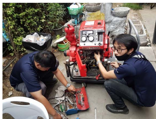
เครื่องสูบน้ำดับเพลิงชนิดหาม ภาพที่ 2.2-13 ระบบป้องกันอัคคีภัยภายในโครงการ
