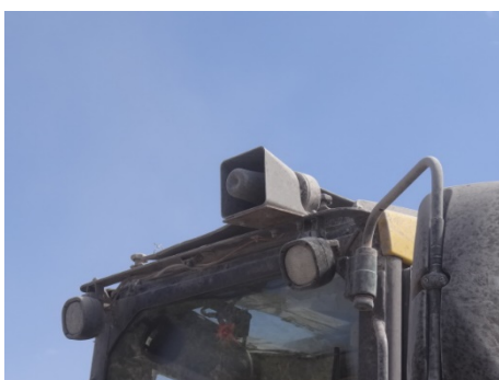
รูปที่ 2-23: หวอสัญญาณเตือนการระเบิด
