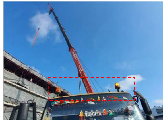
รูปที่ 2-56 สัญญาณไฟกระพริบขณะปั้นจั่นทำงาน
