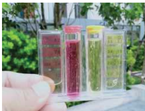
ภาพที่ 3.5.4-1 การตรวจวัด pH และ Cl_2 สระว่ายน้ำ
