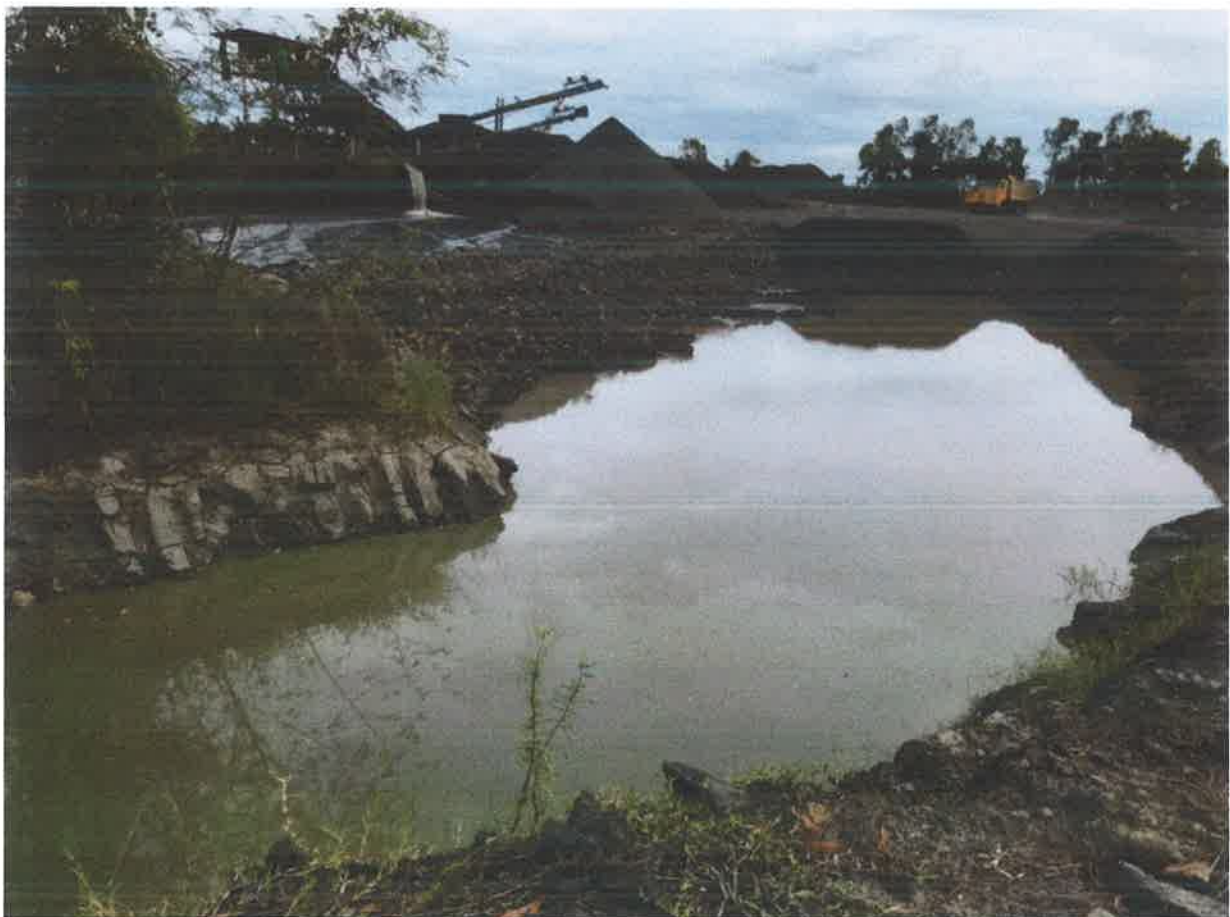
รูปที่ 7 บ่อน้ำคักตะกอนและใช้เติมรดน้ำเพื่อใช้โรการรด/สเปรย์ถนนลำเลียงหินป้องกันฝุ่นและใช้เพื่อสเปรย์ในระบบฝุ่นของโรงโม่
