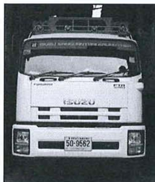
รถบรรทุกแบบควบคุมอุณหภูมิ ไม่เกิน ๑๐ °C พร้อมลิฟท์ยกท้าย
