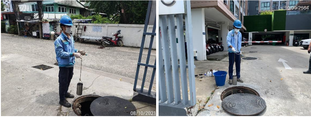
ภาพที่ 3.5.3-1 การเก็บตัวอย่างน้ำระบบบำบัดน้ำเสีย
