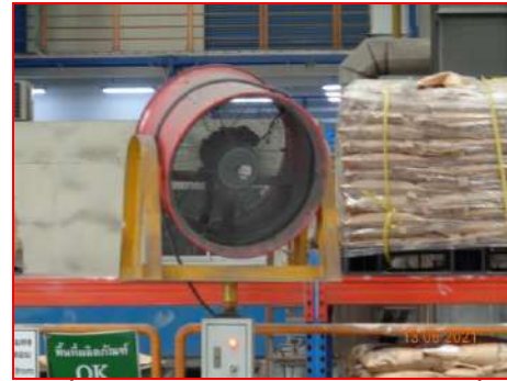
ภาพที่ 2-24 พัดลมระบายอากาศ บริเวณเสียง ต่อการสะสมความร้อน
