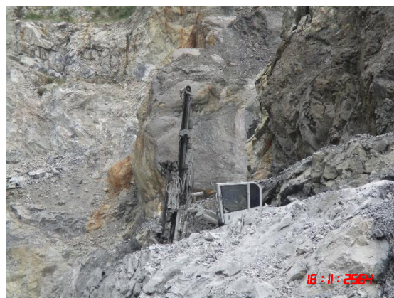
รูปที่ 2-3 รถเจาะระเบิดที่มีเครื่องดูดฝุ่นติดตั้งที่บริเวณหัวเจาะ
