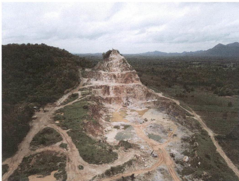
รูปที่ 1 แสดงสภาพพื้นที่หน้าเหมืองบริเวณด้านทิศตะวันออกของประทานบัตร เดินหน้าเหมืองไปทางทิศเหนือ มีการทำเหมืองเป็นแบบชั้นบันได
