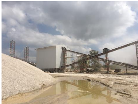
รูปที่ 2-19: การปิดคลุมสายพานลำเลียง
