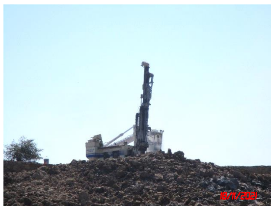
รูปที่ 2-21 เครื่องเจาะรื้อระเบิดที่มีอุปกรณ์เก็บฝุ่นติดไว้กับหัวเจาะ
