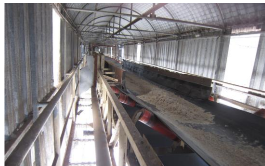
รูปที่ 8 ฝาคกรอบและหัวฉีดน้ำ บริเวณสายพานลำเลียงขานอ้อย
