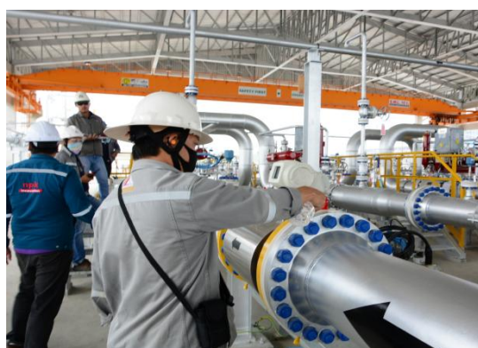
รูปที่ 3-13 การตรวจสอบการรั่วไหลของก๊าซ
