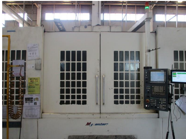
รูปที่ 2-48 เครื่องจักร CNC มีระบบ Interlock กรณีเครื่องจักรทำงานจะทำการปิดประตูอัตโนมัติ
