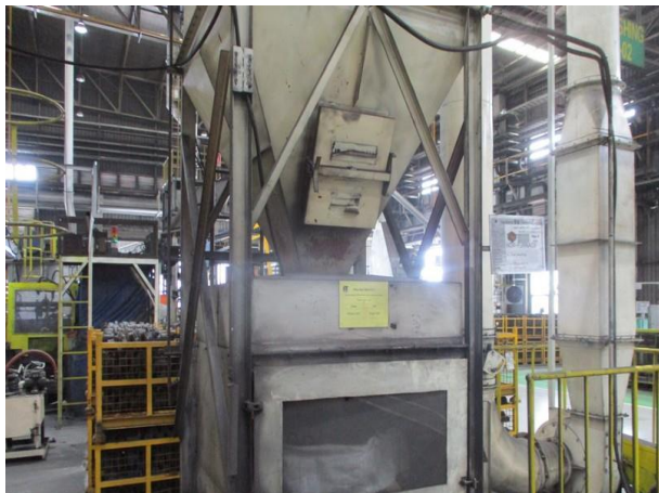
รูปที่ 2-39 Big bag เพื่อรองรับฝุ่นละอองจากการเคาะฝุ่นออกเป็นจังหะของระบบถูกรองของ เครื่องขัดผิวชิ้นงาน และมีตู้ปิดมิดชิด
