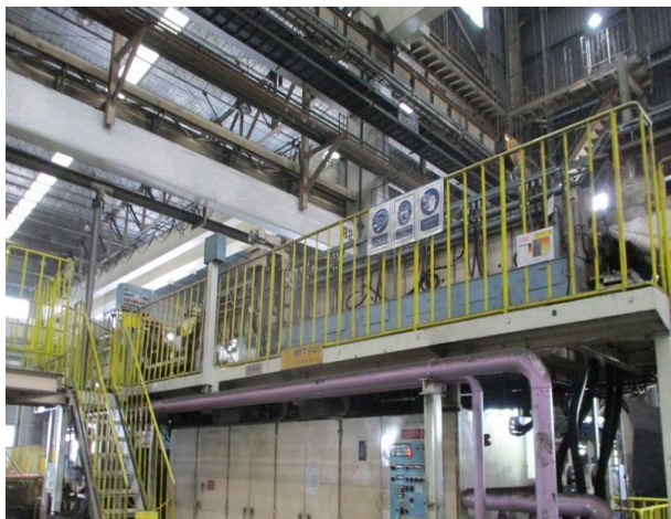
รูปที่ 2-30 แยกพื้นที่ระหว่างพนักงานและเครื่องให้ความร้อนเหล็กท่อน โดยติดตั้งเครื่องจักรบนชั้นลอย
