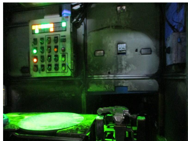
รูปที่ 2-46 การติดตั้ง Photo sensor เพื่อป้องกันเครื่องจักรหนีบ/กระแทก เกิดอันตรายกับพนักงานทำงานกับเครื่องตรวจสอบรอยร้าว
