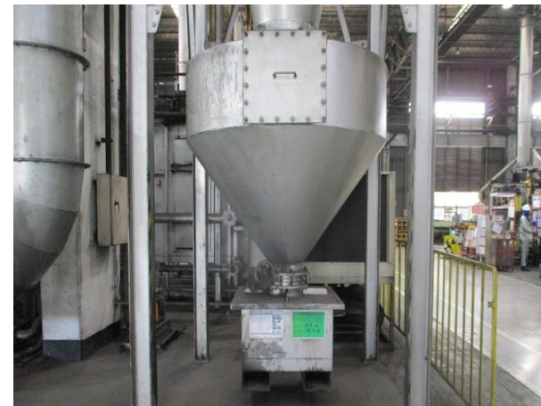
รูปที่ 2-38 Big bag เพื่อรองรับฝุ่นละอองจาก Cyclone และมีตู้ปิดมิดชิด เพื่อป้องกันการฟุ้งกระจาย
