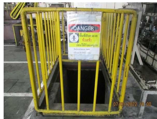
รูปที่ 2-18 บ่อคอนกรีตเก็บน้ำมันเปื้อนน้ำมันใต้เครื่องทุบขึ้นรูป
