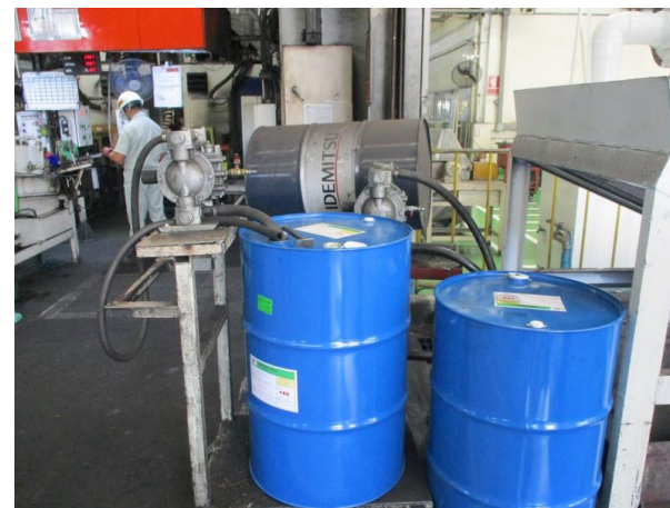
รูปที่ 2-51 การเปลี่ยนถ่ายน้ำมัน มีภาชนะรองรับที่มีฝาปิดมิดชิด
