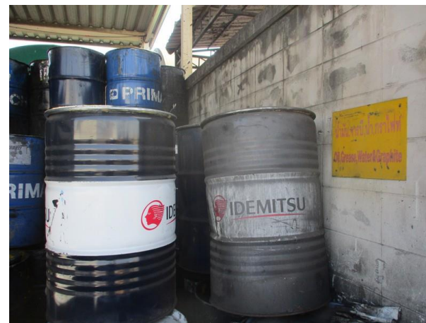
รูปที่ 2-43 ภาพขณะรองรับการถ่ายน้ำมัน ที่มีฝาปิดมิดชิด และเคลื่อนย้ายไปเก็บที่โรงเก็บของเสียอันตรายพร้อมติดป้ายชี้บ่ง
