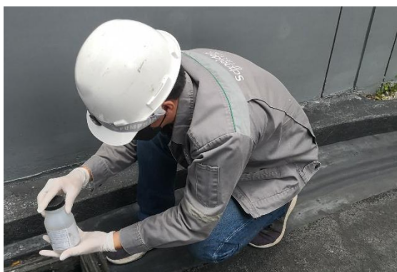
รูปที่ 2-74 การเก็บตัวอย่างน้ำจากระบบบำบัดน้ำเสีย
