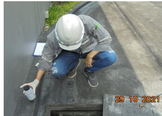
รูปที่ 2-74 การเก็บตัวอย่างน้ำจากระบบบำบัดน้ำเสีย
