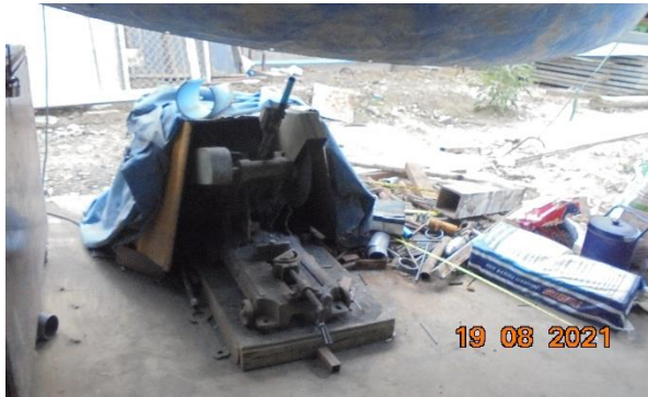
รูปที่ 2-45 พื้นที่สำหรับการเชื่อมตัดโลหะ และที่จัดเก็บวัสดุตัดไฟอยู่ในพื้นที่เฉพาะ และมีระยะที่เหมาะสม
