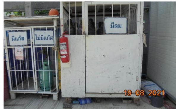
รูปที่ 2-45 พื้นที่สำหรับการเชื่อมตัดโลหะ และที่จัดเก็บวัสดุตัดไฟอยู่ในพื้นที่เฉพาะ และมีระยะที่เหมาะสม
