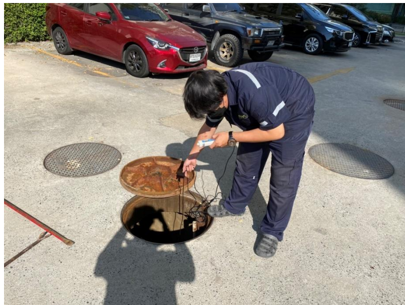
รูปที่ 14 ดำเนินการตรวจวัดค่า DO ป่อเติมอากาศระบบบำบัดน้ำเสีย Plant 1-4
