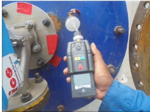
รูปที่ 2-32 การทดสอบการรั่วซึม Leak Test บริเวณข้อต่อ และหน้าแปลนภายในกระบวนการผลิต
