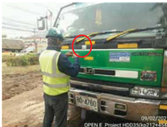
รูปที่ 2-7 สติกเกอร์แบบรหัสสีแสดงการตรวจสอบของเครื่องจักรและอุปกรณ์ต่างๆ
