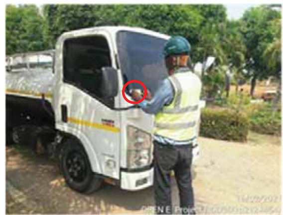
รูปที่ 2-7 สติกเกอร์แบบรหัสสีแสดงการตรวจสอบของเครื่องจักรและอุปกรณ์ต่างๆ
