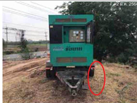
ค) การติดตั้งสายดิน และตรวจวัดกระแสตามมาตรฐานความปลอดภัย
