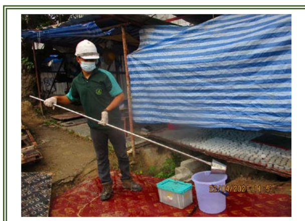
รูปที่ 3-14 การเก็บตัวอย่างคุณภาพน้ำทิ้ง บริเวณบ่อบำบัดน้ำทิ้งชั่วคราวสุดท้ายก่อนระบาย ออกกระบะระบายน้ำทิ้งสาธารณะ
