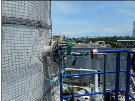
รูปที่ 3.6 การเก็บตัวอย่างคุณภาพอากาศในปล่องระบาย บริเวณ เตาเผาก๊าซจากกระบวนการผลิต-ZCT2
