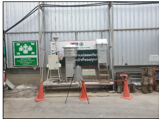
ภาพที่ 22 ติดตั้งเครื่องตรวจวัดคุณภาพสิ่งแวดล้อม
