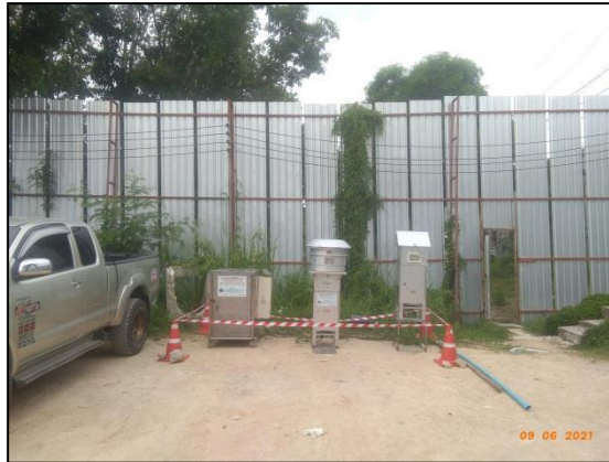
รูปที่ 3.1 การเก็บตัวอย่างคุณภาพอากาศในบรรยากาศ บริเวณ ภายในพื้นที่ก่อสร้างโครงการ
