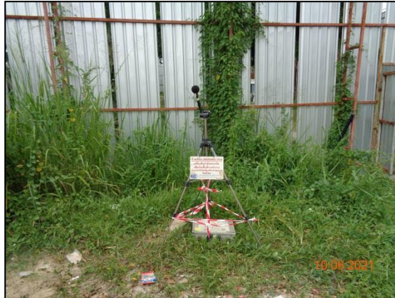
รูปที่ 3.3 การตรวจวัดระดับเสียงโดยทั่วไปและเสียงรบกวน บริเวณ ภายในพื้นที่ก่อสร้างโครงการ
