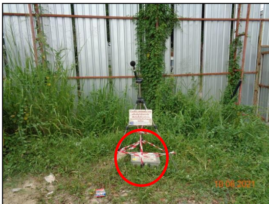
รูปที่ 3.5 การตรวจวัดความสั่นสะเทือน บริเวณ ภายในพื้นที่ก่อสร้างโครงการ
