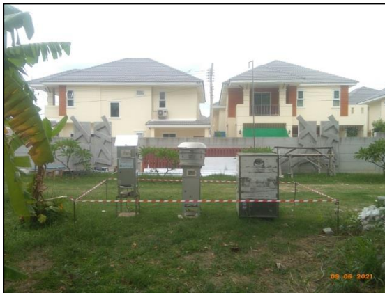
รูปที่ 3.2 การเก็บตัวอย่างคุณภาพอากาศในบรรยากาศ บริเวณ พื้นที่หมู่บ้านเพอร์เฟคโฮม
