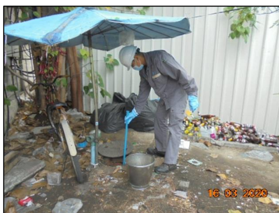
รูปที่ 3.22 การเก็บตัวอย่างคุณภาพน้ำทิ้ง บริเวณน้ำทิ้งที่ออกจากบ่อพักน้ำทิ้งจากการล้างตู้ Container ของ ICD
