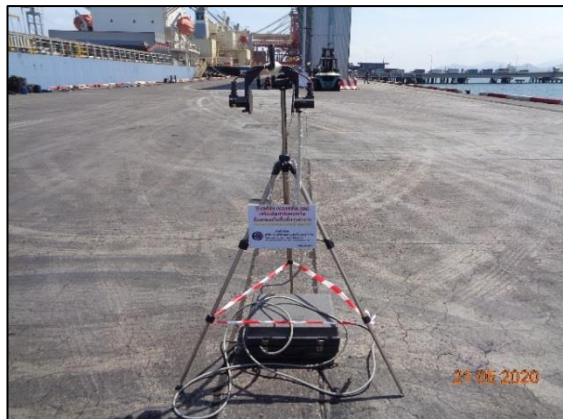
รูปที่ 3.2 การตรวจวัดค่าความทึบแสง บริเวณ หน้าท่าเรือที่มีการขนถ่ายสินค้าเทกองด้านทิศใต้
